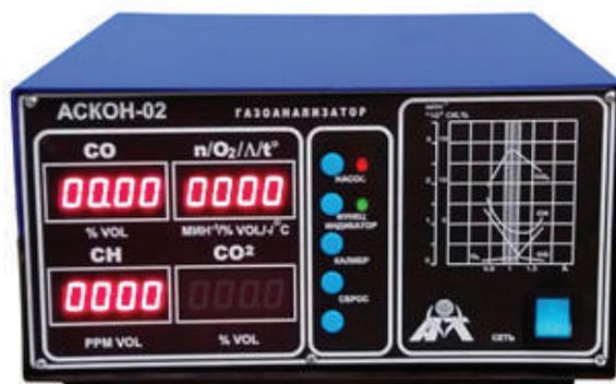
Рисунок 4. Вид газоанализатора спереди
