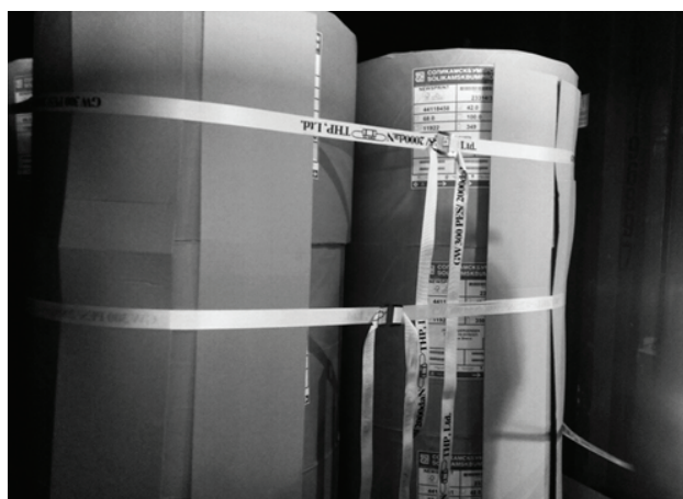
Рисунок 2. Пример крепления лентой полиэфирной рулонов бумаги в 40 футовом контейнере
