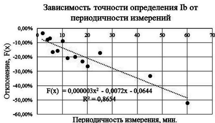
Рисунок 6. Динамика зависимости точности определения I_b при различных интервалах проведения замеров при наличии светофорного объекта и НПП
