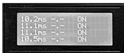
Рисунок 10. Контроль времени впрыска топлива на дисплее разработанного прибора «ДБД-4»
