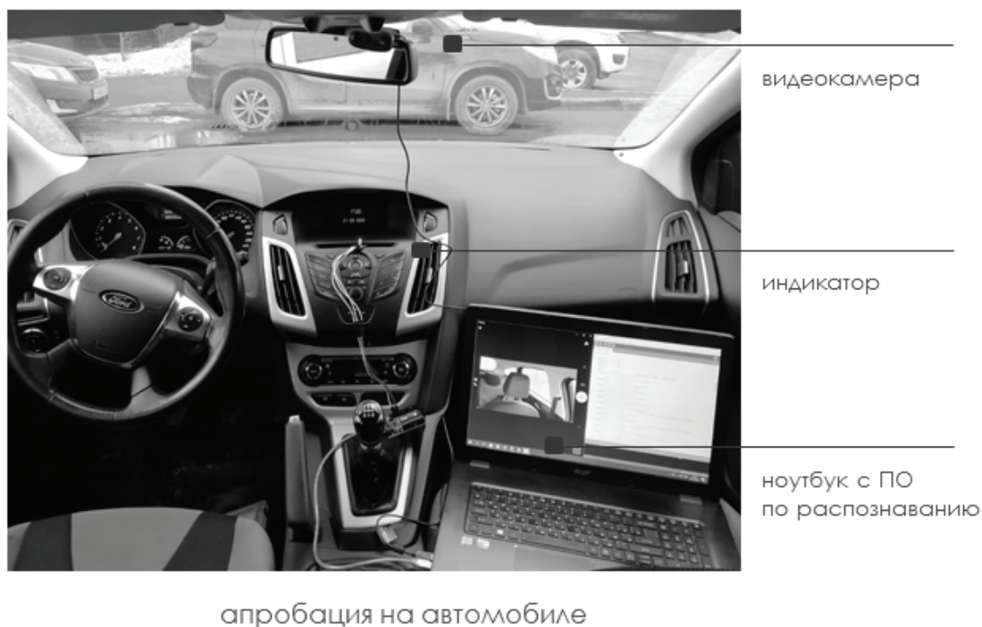
Рисунок 6. Апробация прототипа системы на автомобиле Ford Focus 3
