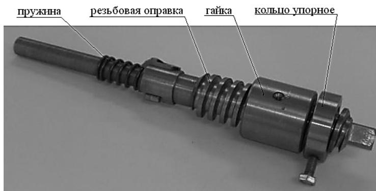
Рисунок 10. Резьбовая оправка с гайкой и упорным кольцом в сборе
