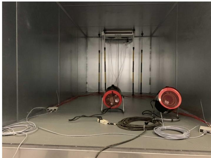
Рисунок 3. Размещение в фургоне обогревателей и датчиков измерения температуры
