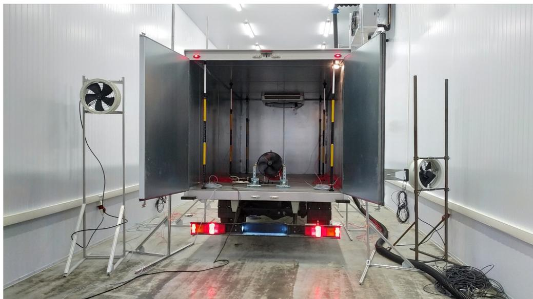
Рисунок 2. Изотермическая камера с установленным транспортным средством-рефрижератором и испытательным оборудованием
