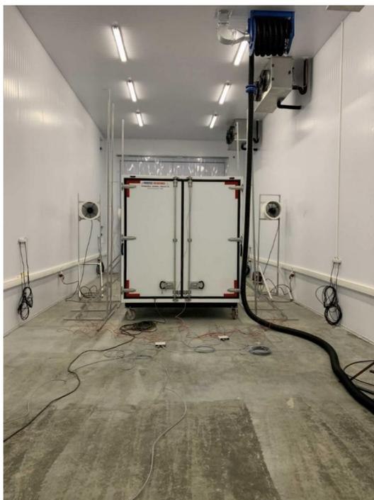
Рисунок 1. Изотермическая камера с испытательным оборудованием и с установленным калориметром (имитатор изотермического фургона транспортного средства)
