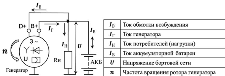
Рисунок 2 – Схема СЭ автомобиля
