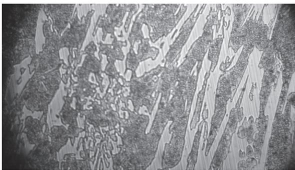
б)  $t_{\text{зак}} = 800 \text{ }^\circ\text{C}$  – выдержка 12 мин., охл. на воздухе, твердость 50 HRC, мартенситно-трооститная основа, ледебуритная эвтектика и карбиды,  $\times 500$
