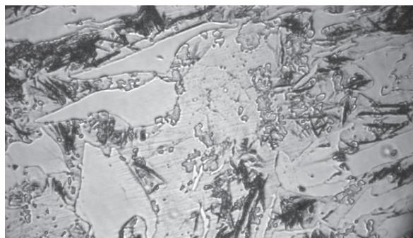
ж)  $t_{\text{зак}} = 1000 \text{ }^\circ\text{C}$ , – 8 мин., охл. в масле, твердость 62 HRC, мартенситно-аустенитная основа, ледебурит и включения карбидов,  $\times 500$
