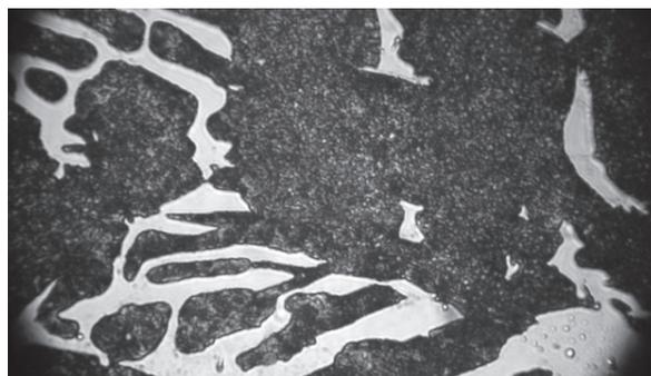
в)  $t_{\text{зак}} = 800 \text{ }^\circ\text{C}$  – 12 мин, охл. в масле твердость 65 HRC, мартенситно-аустенитная основа, ледебурит и карбиды,  $\times 500$
