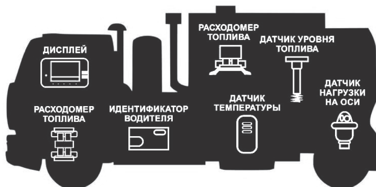
Рисунок 3. Схема расположения датчиков на современном автомобиле-топливовозе
