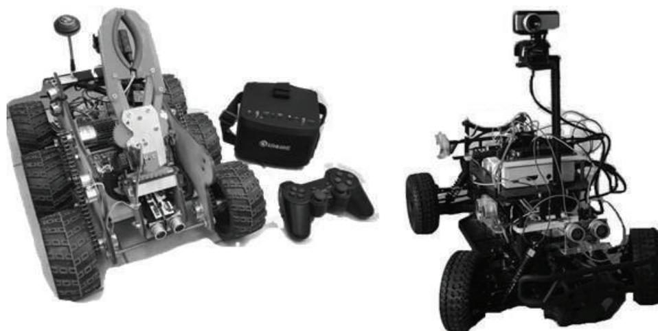
Рисунок 2. Масштабные модели беспилотных транспортных средств: слева – модель спецтехники повышенной проходимости с манипулятором, справа – модель легкового автомобиля
