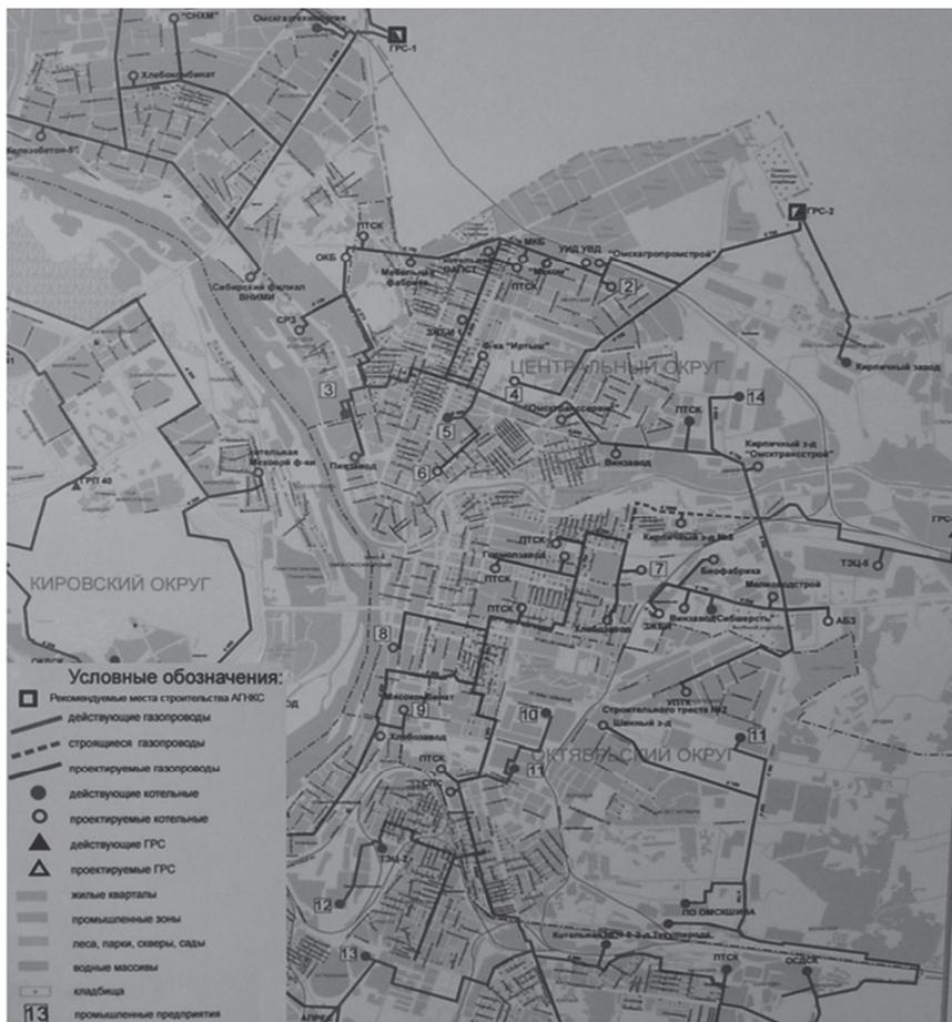
Рисунок 1. Возможные варианты дислокации АГНКС относительно существующей газовой инфраструктуры в городе Омске [8]
