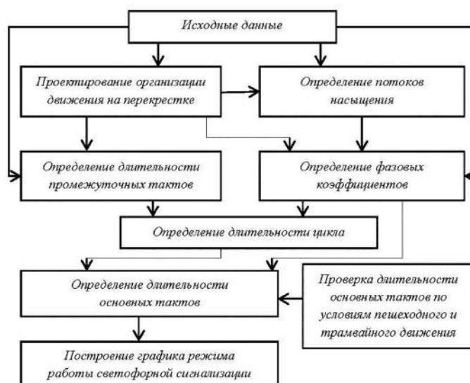
Рисунок 3. Последовательность расчёта длительности светового цикла и его элементов Источник: разработано Гасиловой О. С.
