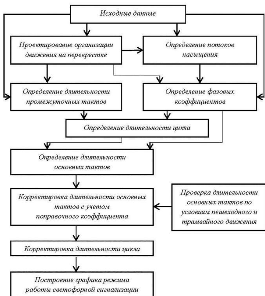
Рисунок 4. Предлагаемая последовательность расчёта длительности цикла и его элементов Источник: разработано Гасиловой О. С.
