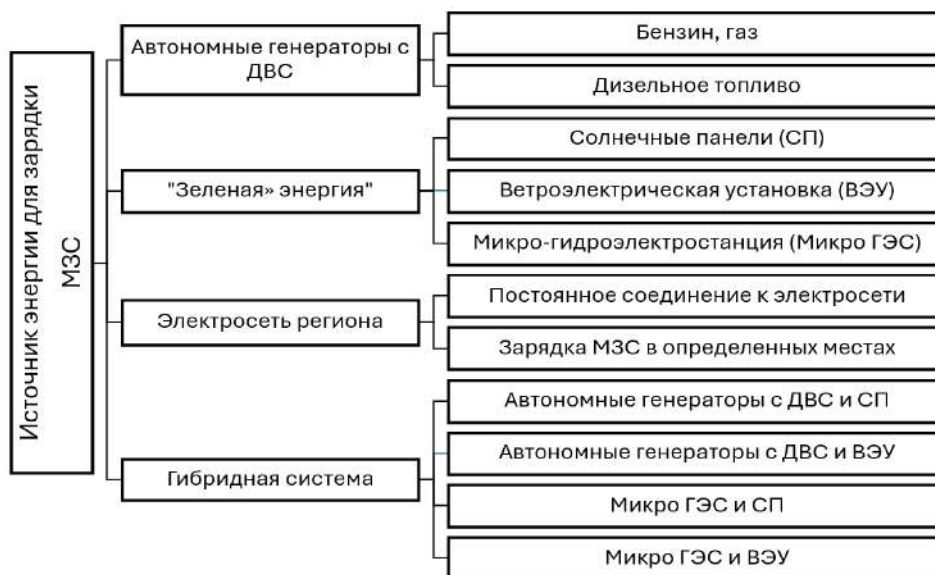
Рисунок 6. Виды источников энергии для зарядки МЗС на базе аккумуляторных батарей Источник: составлено автором
