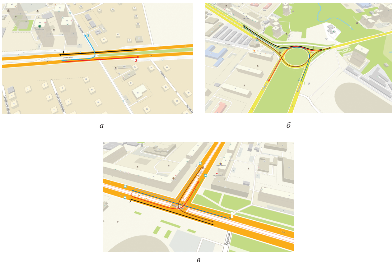
Рисунок 2. Типы основных пересечений улично-дорожной сети в городе Перми: Х-образное (а; пересечение «улица Уинская – улица Грибоедова»), кольцевое (б; пересечение «улица Уинская – улица Тургенева – улица Макаренко») и Т-образное (в; пересечение «улица Крупской – улица Уральская»); стрелками и цифрами указаны направление возможного движения (комментарии в тексте)
