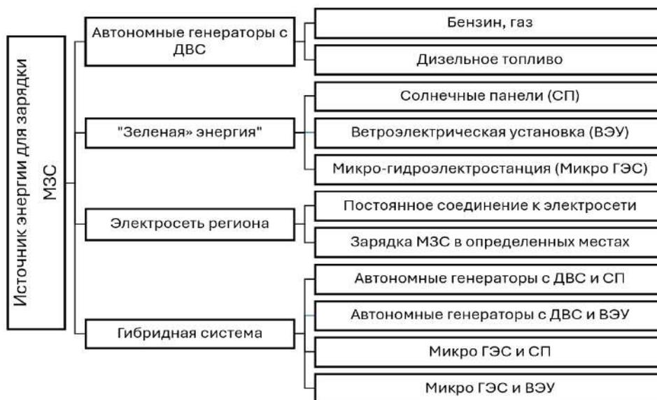
Рисунок 6. Виды источников энергии для зарядки МЗС на базе аккумуляторных батарей
