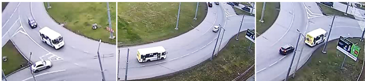
Рисунок 6. Случаи выхода части транспортных средств потока q_{CR} на правую полосу, по которой движется правоповоротный поток q_{ER} (см. рисунок 5)
