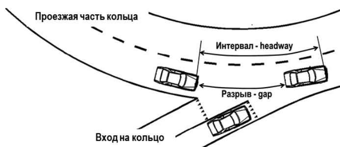
Рисунок 2. Определение интервалов в потоке на кольцевой проезжей части
