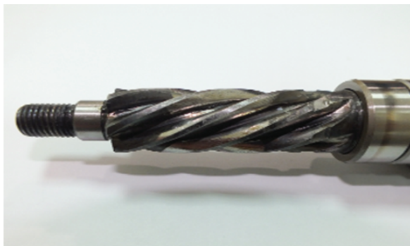
Рисунок 3. Ведущая шестерня рулевой рейки Источник: разработано авторами
