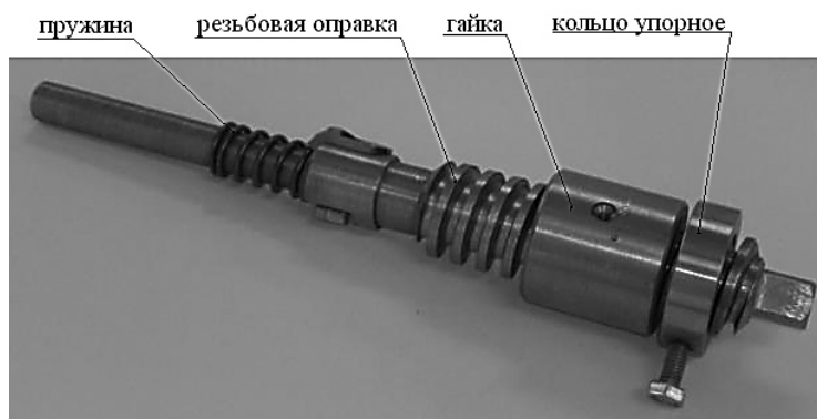
Рисунок 10. Резьбовая оправка с гайкой и упорным кольцом в сборе Источник: разработано авторами [14]
