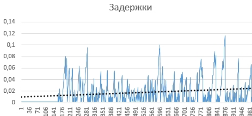
Рис. 5. Задержки пакетов. Горизонтальная ось показывает количество пакетов, вертикальная ось — время в секундах
