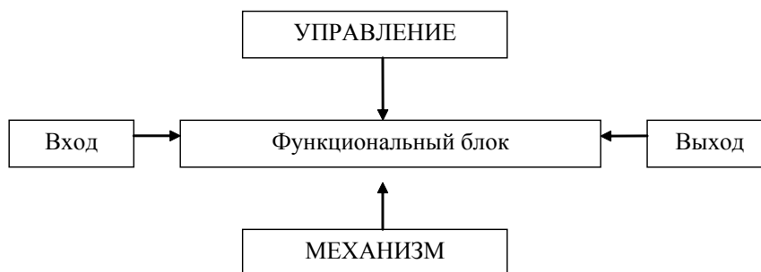
Рис. 2. Функциональный блок модели процесса
